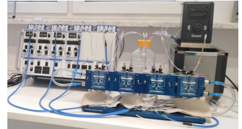
Ryc.5 Aparat do wykonywania badań ICM wyposażony w 4 komory Usinga umożliwiające jednoczesne badanie 4 wycinków
